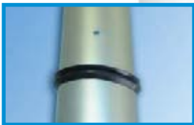
Water drainage holes to avoid ice formation at low temperatures Entwässerungslöcher fürs festfrieren zu vermeiden
